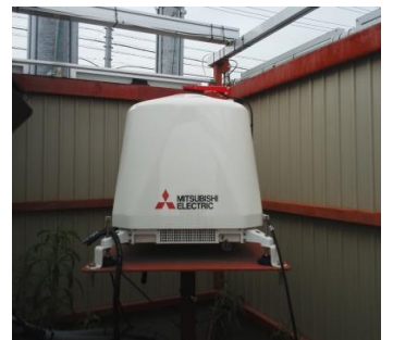
レーザを使って、地上から風の強さを測れるように！！
