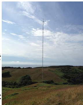
観測したい地点の高さまでポールを建てて風の強さを測っていたのが・・・
